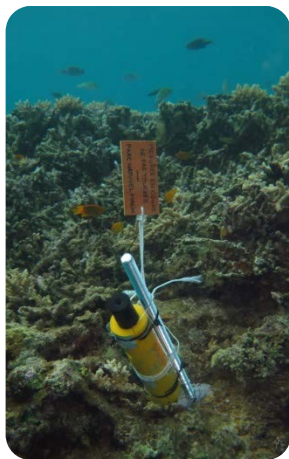
Déploiement d'une sonde TD température/pression
