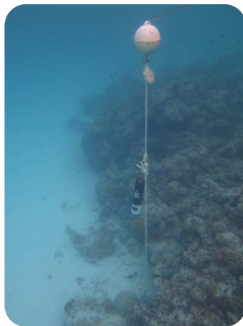
Déploiement d'une sonde SMATCH multi paramètres
