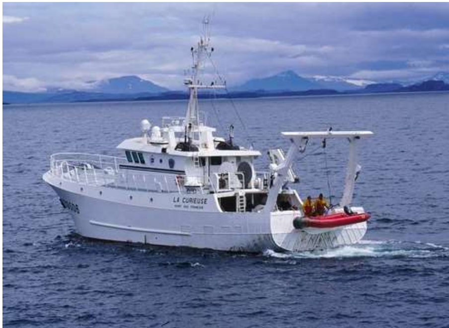
Photo 66. « La Curieuse », navire océanographique de 25 m de type chalutier de pêche arrière
